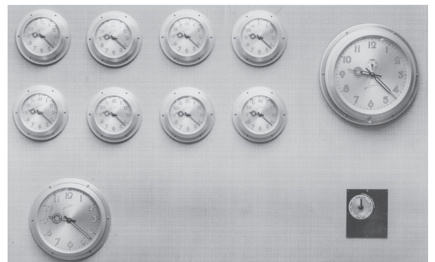
Luftschiffanlage von Junghans von 1935, bestehend aus einer Hauptuhr und mehreren Nebenuhren.
